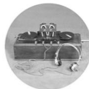
Detector magnetico Marconi con meccanismo ad orologeria e doppio auricolare, modello prodotto dalla Marconi's Wireless Telegraph Company, 1905-1915
