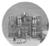
Primo Ricevitore a cristallo e valvola termoionica, costruito da Esercito Italiano su specifiche Marconi. 1915
