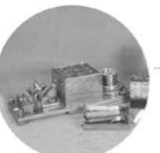
Ricevitore di tipo sintonico collegato ad una macchina stampante morse, modello impiegato nella prima trasmissione transatlantica, 1899-1901
